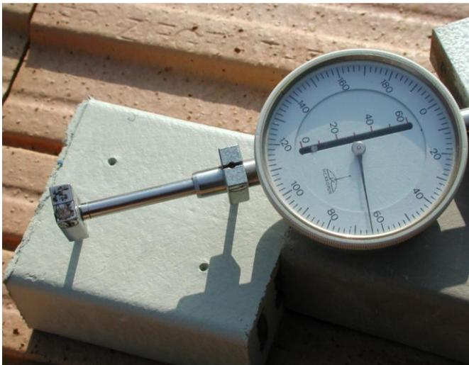
*Abb. 4: Rohling mit Schwindmarken*
