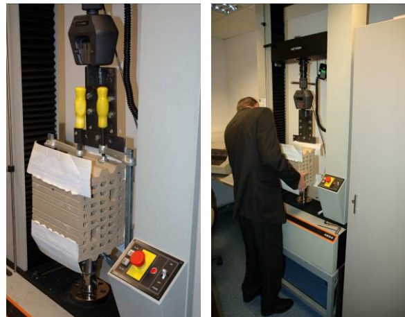
Abbildung 2: Klebezugfestigkeitsprüfungen mit dem POROTHERM 20-25 Lehm
