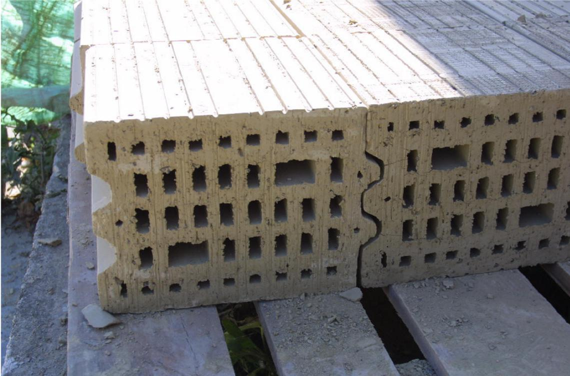
Der im Projekt LEHM.konkret entwickelte, industriell gefertigte Lehmziegel wurde hinsichtlich Materialmischung, Formgebung und Lochdesign optimiert.
